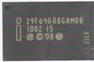
Рис. 1. Микросхема памяти Intel 29F64G08CAMDB
